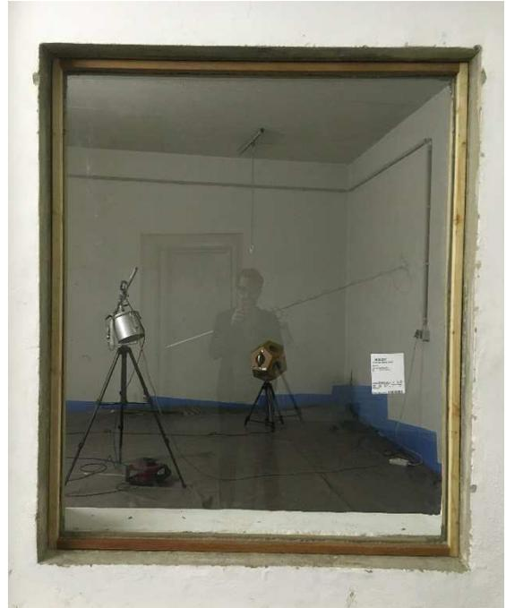
**Bild A.2.2:** Geprüfte Verglasung
