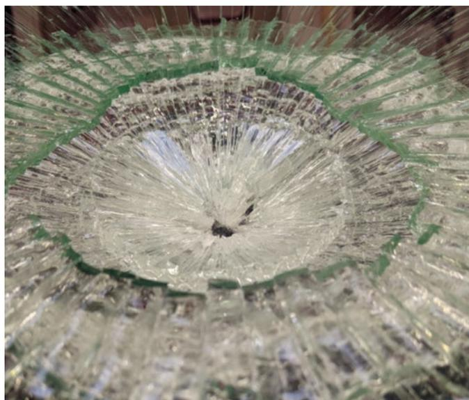
**Bild 9** Versagen innerhalb der oberen Glasscheibe eines TVG (Aufbau 6.0,76.T, Fallhöhe = 8 m) (Quelle: Institut für Baukonstruktion)
