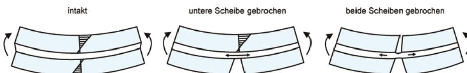
**Bild 1** Belastung der Zwischenschicht bei unterschiedlichen Lastfällen (Quelle: Institut für Baukonstruktion)
