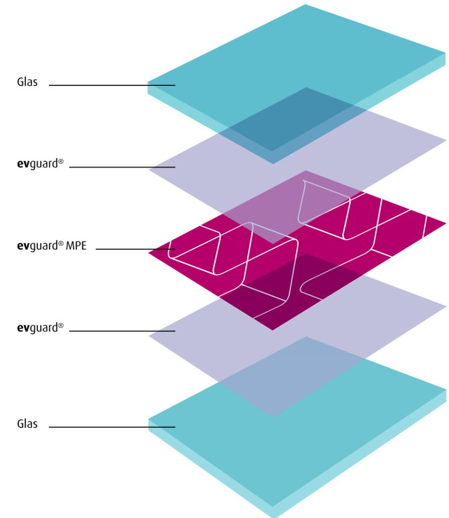
Die Folienwerk Wolfen GmbH bietet zudem eine PET-MPE-Folie („100% modifiziertes Co-Polyester“) an, die in Kombination mit evguard®, in puncto Stabilität, Haltbarkeit, Schubmodul-Effekt und Bedruckbarkeit einen zusätzlichen Vorteil hat. Durch den Verbund mit evguard®/evguard® MPE als Zwischenschicht – ohne Änderung der Zykluszeiten – ergeben sich hervorragende Ergebnisse in den Laminaten.
